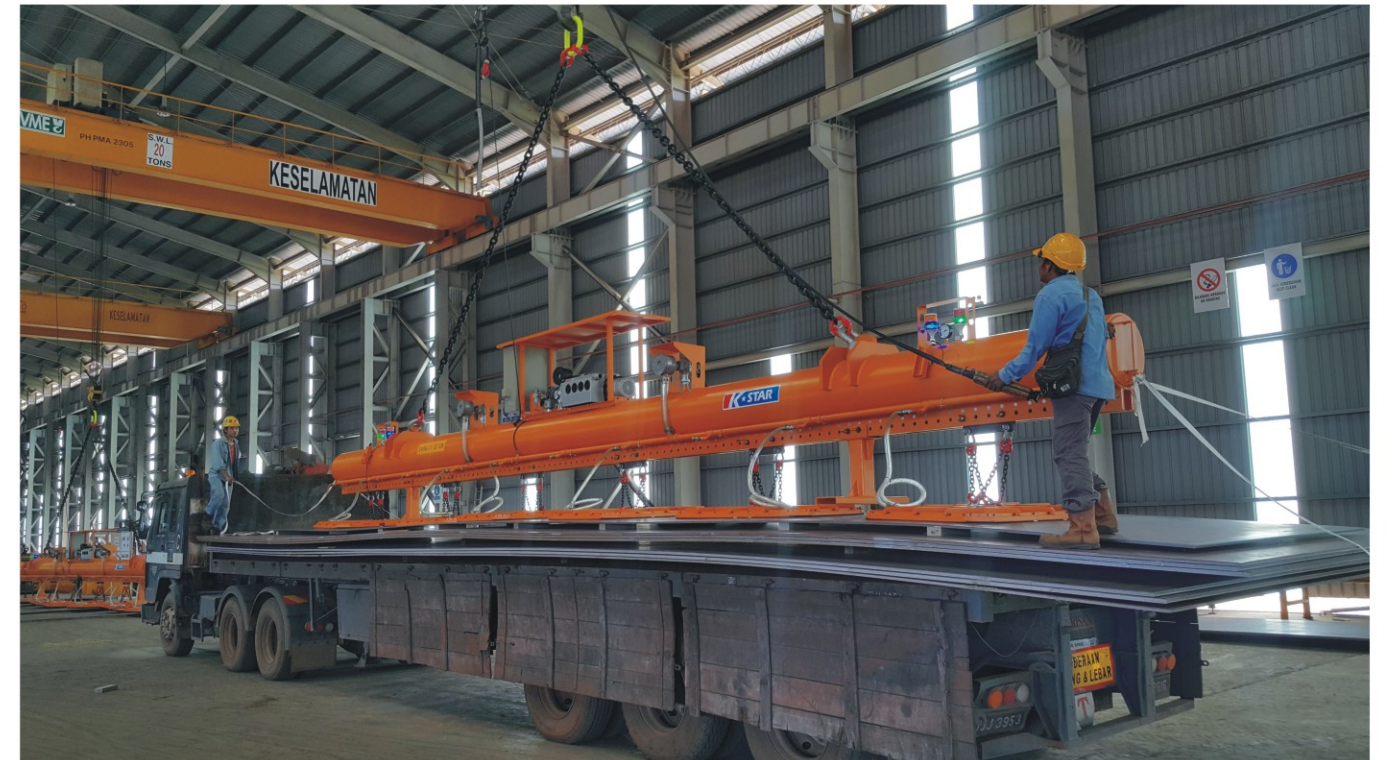
Vacuum lifter for steel plates - 30ton LEVANTADOR AL VACÍO PARA PLACAS DE ACERO - 30ton
