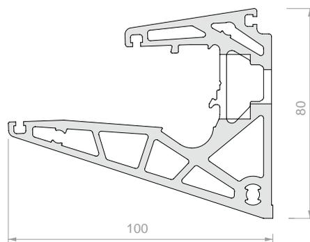
Diseñada para poner un solo vidrio en perfiles largos hasta 3 metros
