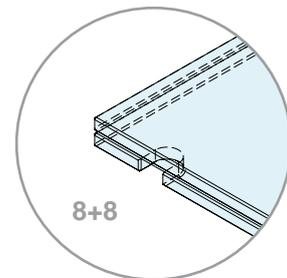
**Nota:** Los mecanizados en el vidrio laminado sólo se deben realizar en el placa inferior.
