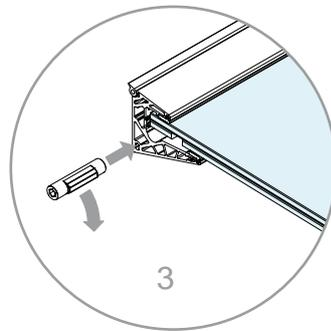
1 - 2 - 3 Instalación de levas de fijación vidrio
