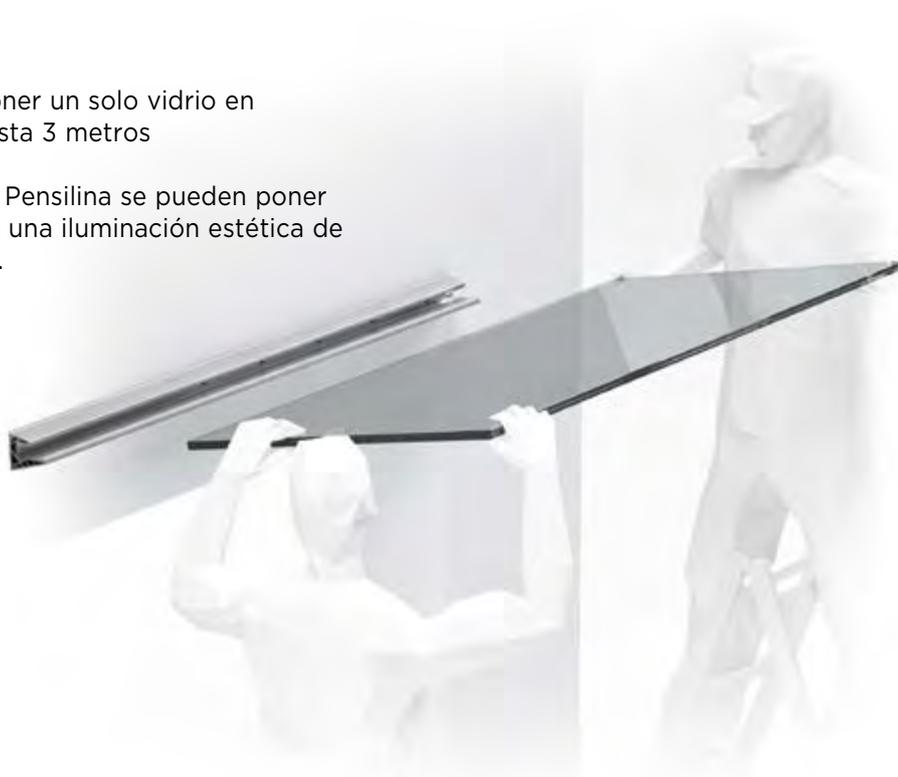
El apriete con leva EasySpeed permite una instalación rápida y sencilla
