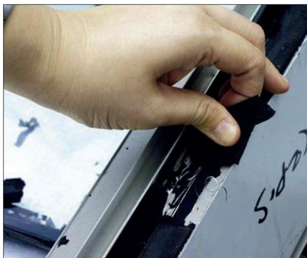
**FIGURA 20** Adhesión incorrecta - test de desmontaje del acristalamiento negativo
