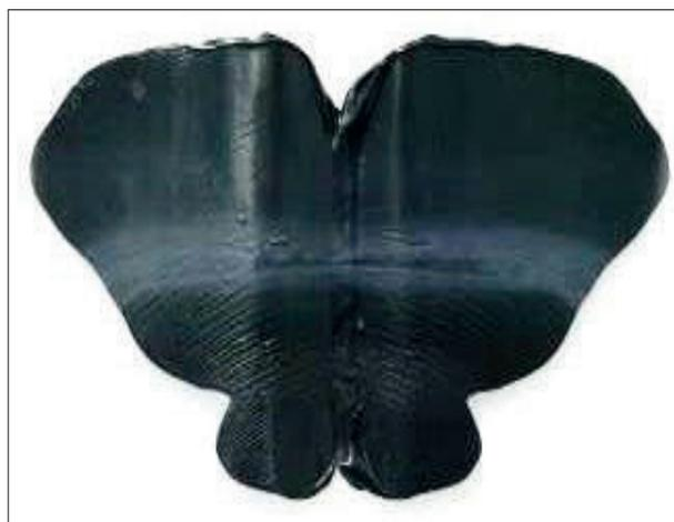
FIGURA 12 Desdoble la lámina – ensayo negativo = mezclado inadecuado
