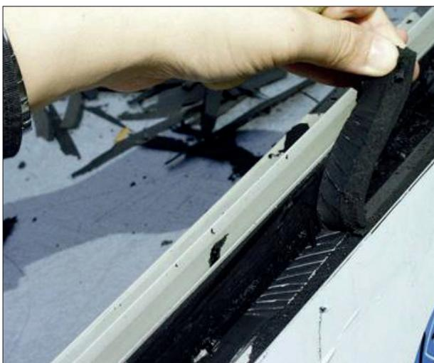
**FIGURA 19** Adhesión correcta - test de desmontaje del acristalamiento positivo
