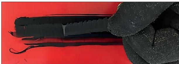
**FIGURA 17** Ensayo de pelado: separación del adhesivo del cordón, fallo cohesivo 100 %
