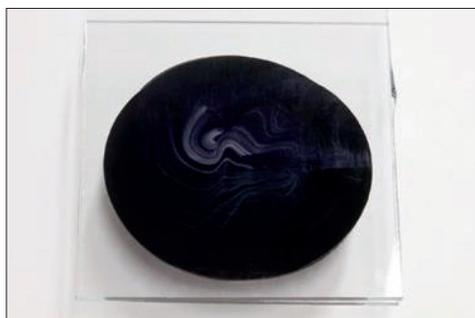
FIGURA 8 Ensayo negativo – mezcla inadecuada
