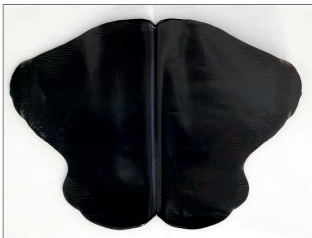
FIGURA 11 Desdoble la lámina – ensayo positivo = mezclado ideal
