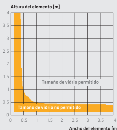
Fig.1 Sólo las cargas climáticas son relevantes en el cálculo de la altura del sellador del doble acristalamiento
