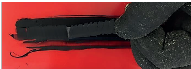
FIGURA 17 Ensayo de pelado: separación del adhesivo del cordón, fallo cohesivo 100 %
