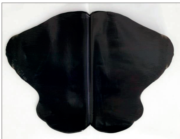
FIGURA 11 Desdoble la lámina – ensayo positivo = mezclado ideal
