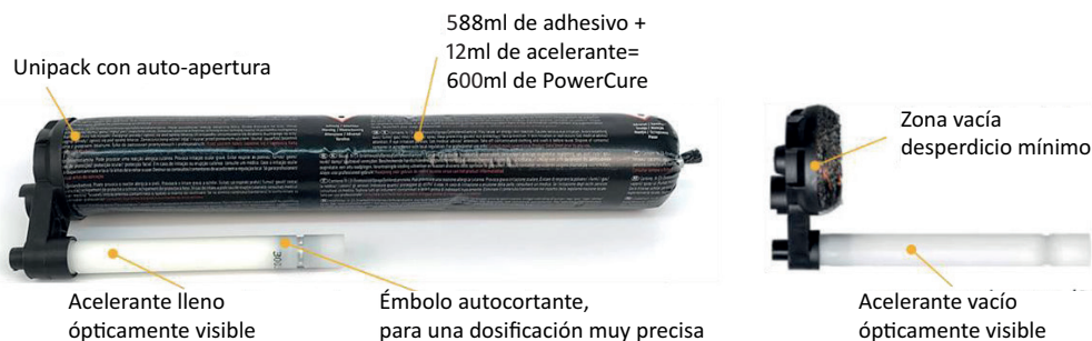
FIGURA 5 PowerCure unipack (Sikasil® WT-66 PowerCure) lleno y vacío – comprobación del uso del acelerante
