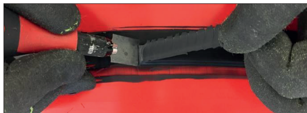
FIGURA 18 Ensayo de pelado en vidrio lacado: el cordón se corta mientras se tira de él
