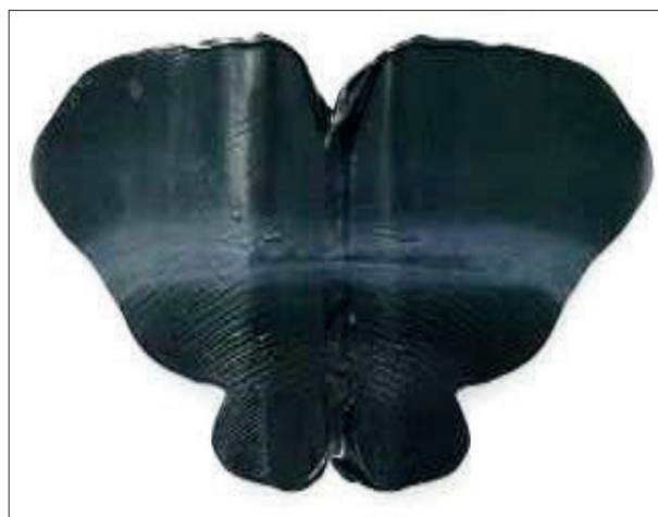
FIGURA 12 Desdoble la lámina – ensayo negativo = mezclado inadecuado
