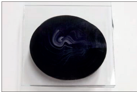
FIGURA 8 Ensayo negativo – mezcla inadecuada
