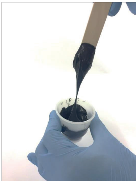
FIGURA 14 El material muestra un comportamiento pastoso; el tiempo abierto no se ha alcanzado aún.
