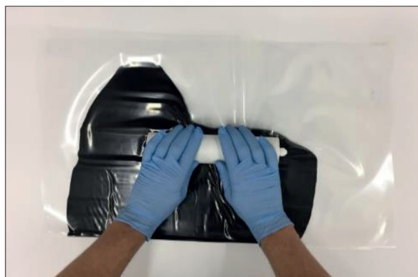
FIGURA 10 Presione el cordón en dirección perpendicular al pliegue
