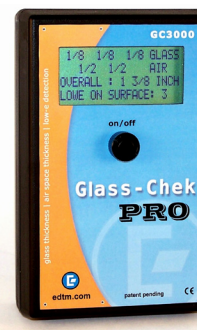
„Glass-Chek PRO“ Erkennt die Stelle und Art der Low-E-Beschichtungen, sowie Glas- und Luftraumdicke. Geeignet für einfach-, doppel- und dreifachverglaste Fenster (Modellnr. GC3000).
