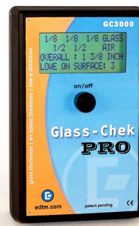
"Glass-Chek PRO" Identifica la ubicación y tipo de la capa de Low-E, además del vidrio y espacio de aire en ventanas de vidrio singular, doble, o triple. (Model# GC3000)
